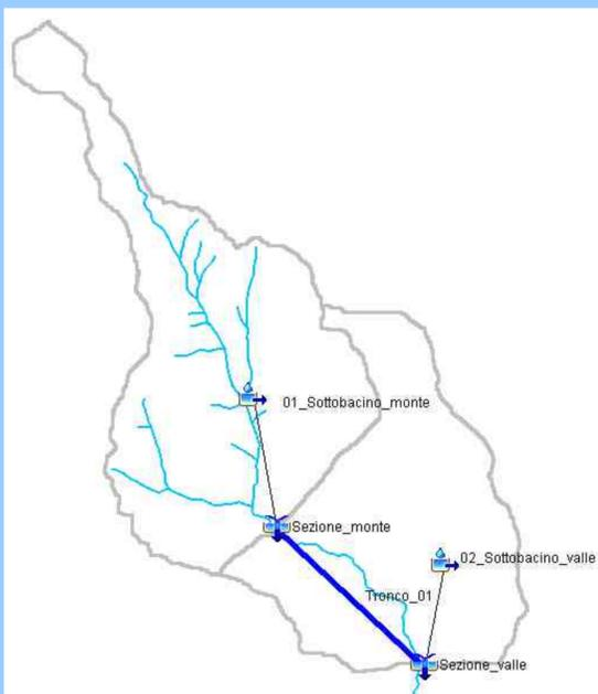
Fig. 4 – Modello fisico del bacino del torrente Rio del Tovo
