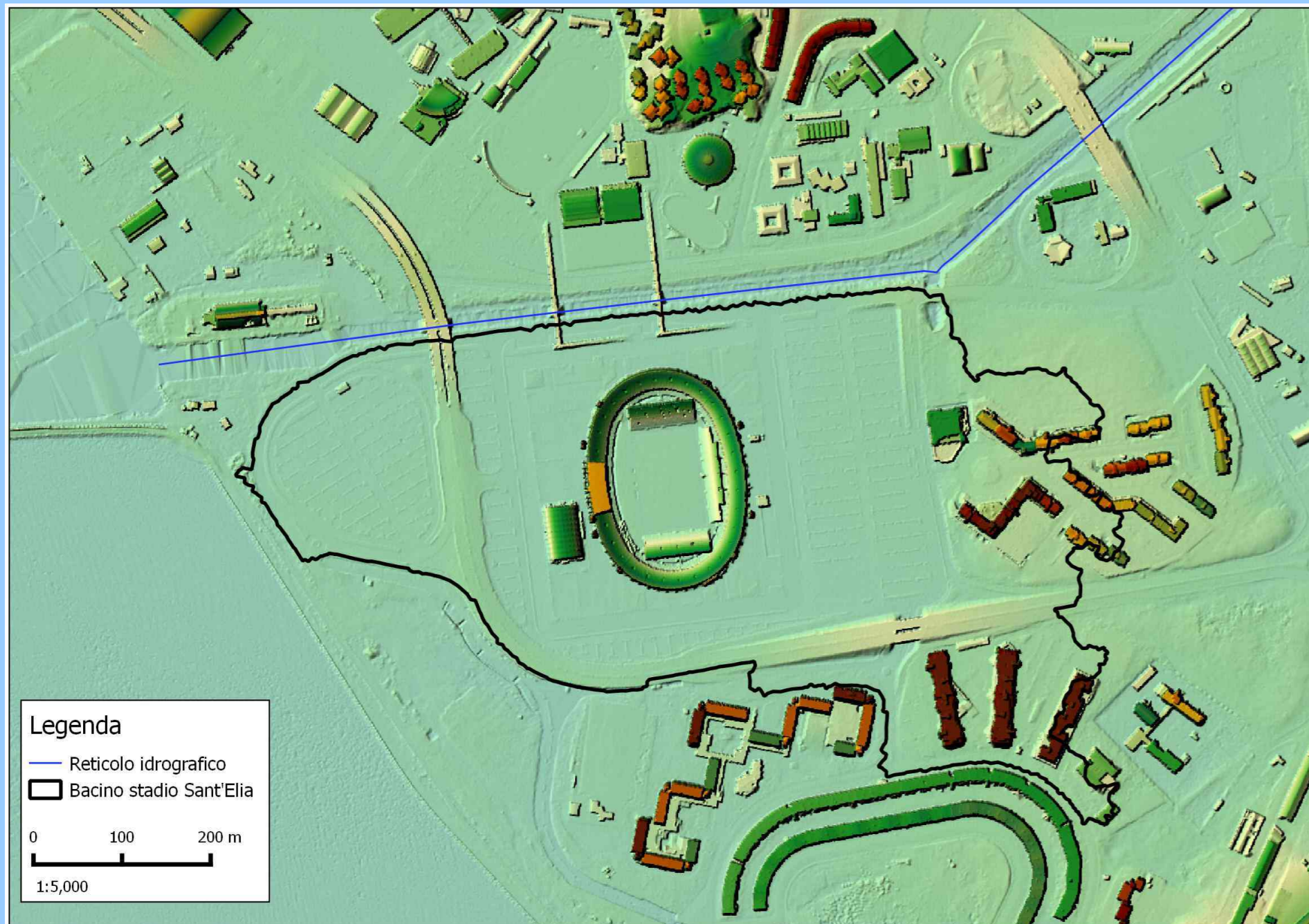
Fig. 1 – Planimetria con individuazione bacino idrografico su modello digitale del terreno
