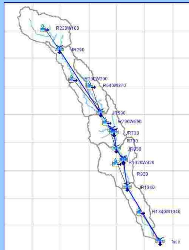
Fig. 2 – Schematizzazione in HEC-HMS
