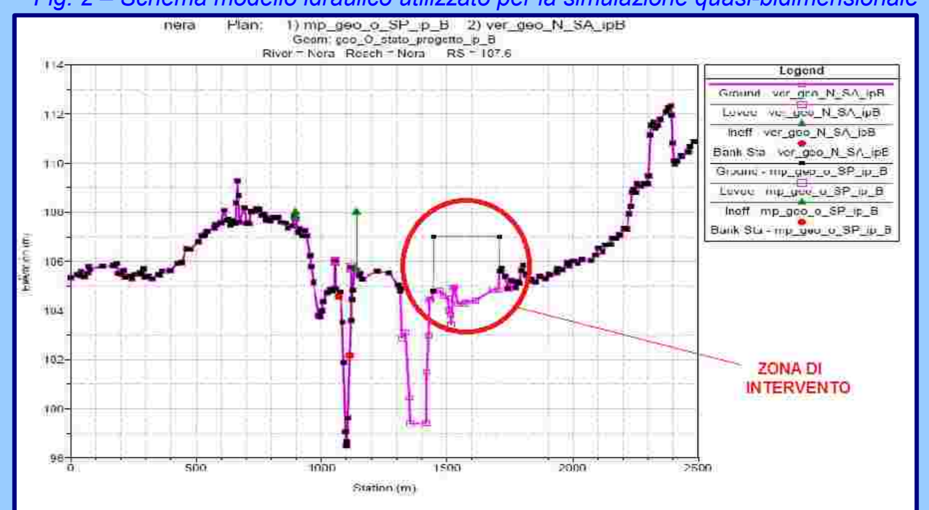
Fig. 3 - Particolare sezione: confronto fra Stato attuale e Stato di progetto
